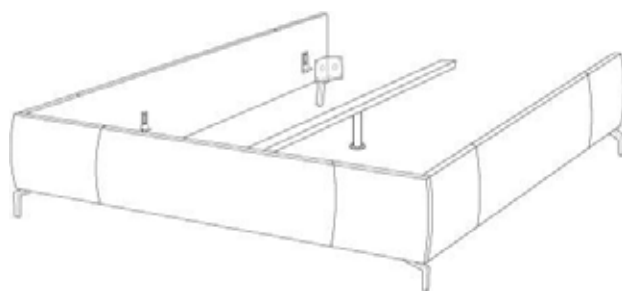
Nahtverteilung bei Lederverarbeitung
